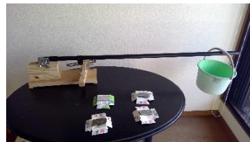
図4：コンクリートに力を加えている様子
