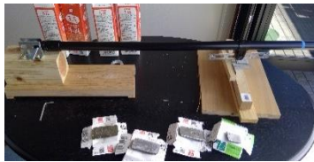
図 8 : コンクリートを二つに割る装置
