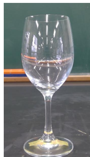
実験で使ったワイングラス 質量 160,2g 固有振動数 1137Hz
